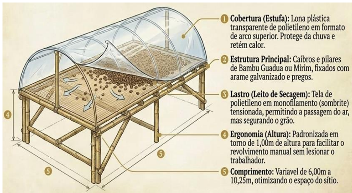
Figura 17. Terreiro suspenso de bambu utilizado na secagem de cafés especiais: inovação tecnológica desenvolvida e aperfeiçoada por cafeicultores do Caparaó. Fonte: elaborada por Maurício Novaes (2026), com auxílio de IA (NotebookLM).
