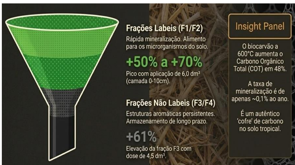
Figura 19. Esquema do fracionamento do carbono (frações lábeis vs. não lábeis) e impacto da temperatura de 600 °C no incremento do Carbono Orgânico Total (COT). Fonte: elaborada por Maurício Novaes (2026), com auxílio de IA (NotebookLM).
