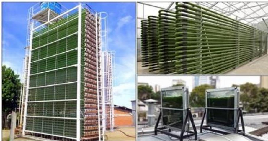
**Figura 2.** Modelos de fotobiorreatores para cultivo de microalgas. Fonte: Imagem da esquerda e inferior direita acervo da (NPDEAS). Imagem superior direita: IGV Biotech. [https://upload.wikimedia.org/wikipedia/commons/b/ba/Photobioreactor\\_PBR\\_4000\\_G\\_IGV\\_Biotech.jpg](https://upload.wikimedia.org/wikipedia/commons/b/ba/Photobioreactor_PBR_4000_G_IGV_Biotech.jpg).
