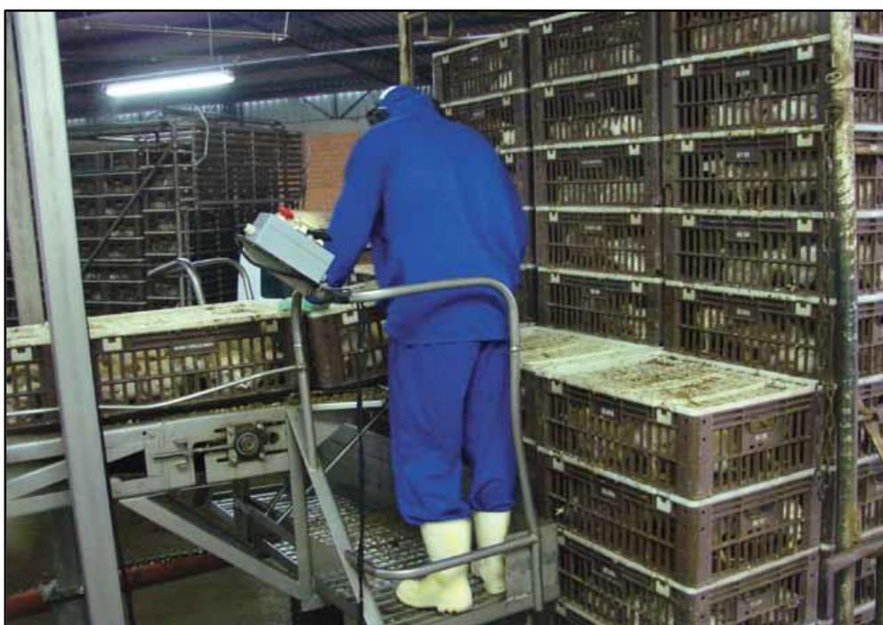
**Figura 3.** Desembarque das caixas com as aves em uma esteira móvel. Fonte: Ludtke *et al.* (2015).
