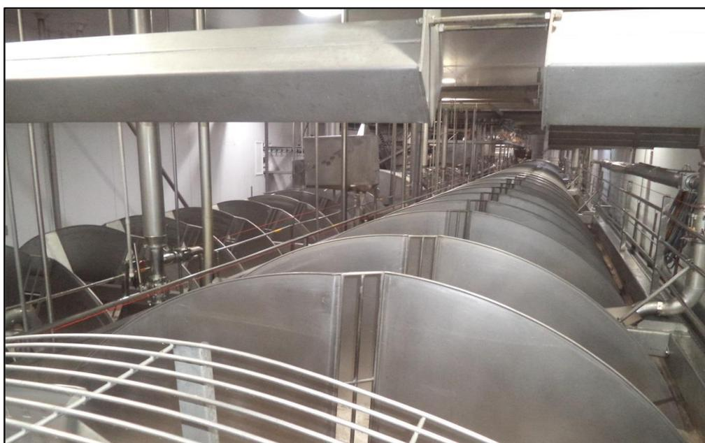
**Figura 11.** Tanques de Chiller de pré-resfriamento e resfriamento. Fonte: MARQUES, L. S. (2018).
