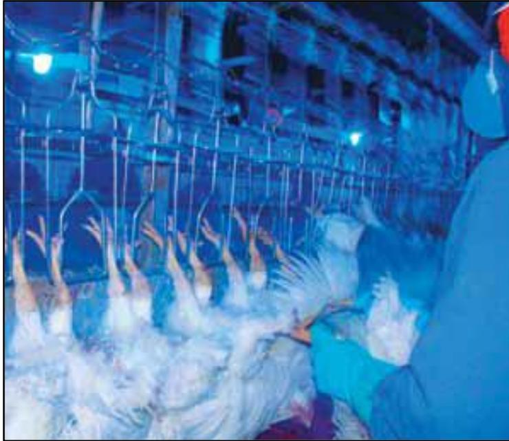
**Figura 5.** Processo de pendura das aves nos ganchos das nóreas. Fonte: Ludtke *et al.* (2015).
