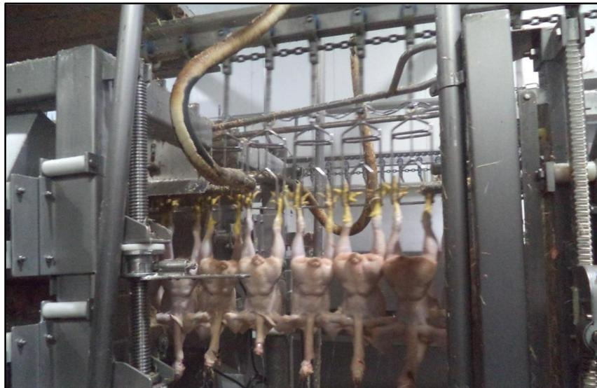
**Figura 9.** Observa-se processo de depenagem. Fonte: MARQUES, L. S. (2018).
